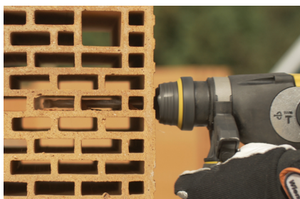
1 Свердління отвору в без ударному режимі
